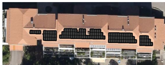
Hus F – 126 paneler
